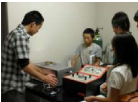
↑走査型電子顕微鏡で観察するために、試料を金メッキしました。
